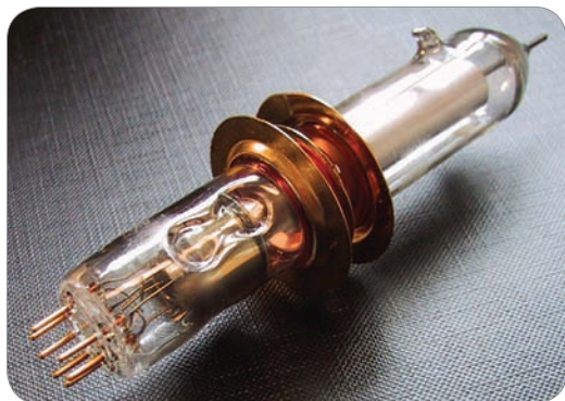
Det FFI-utviklede Floating drift klystronet var refleksklystronet overlegent. Det avbildede røret er fra Sture Kochs samling.
