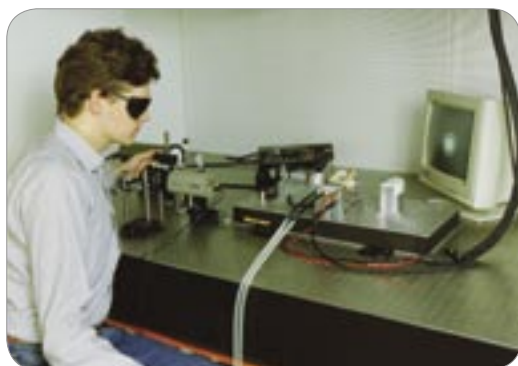
Til venstre: Halvor Ajer prøver ut laboriemodellen av EUCLID RTP8.3 laseren. Som vi ser på TV-monitoren er strålekvantiteten ypperlig. Til høyre: Endelig utgave av laseren, hvor den nederste enheten er utviklet av FFI og Simrad Optronics, mens den øverste er utviklet av Pilkington Optronics i Glasgow.
