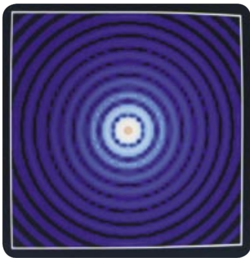
Bølgeoptikk. Perfekt bilde av et fjernt lysende punkt. Ringstrukturen skyldes diffraksjon av lysbølgene.
