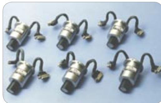
Komplette detektorer levert av FFI tilpasset Philips kjølemaskin for TC10 prod. modell.
