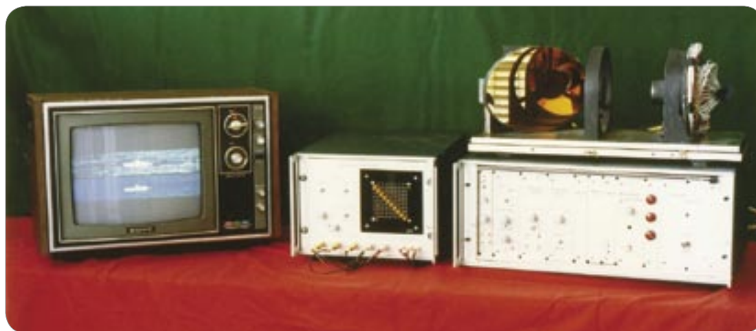
Den første laboratoriemodellen, med optisk hode til høyre, og elektronikken ble konstruert og bygget i løpet av seks måneder, og det første IR-bildet kunne vises på TV-monitor høsten 1974.
