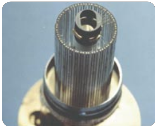
64 element Dewar under montering. De vertikale "strekene" er tilledninger smeltet i glass og var en stor utfordring.
