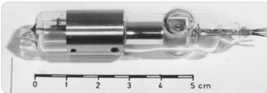
IR-detektor for Penguin Mk1. Detektorelementet skimtes bak safirvinduet til høyre.
