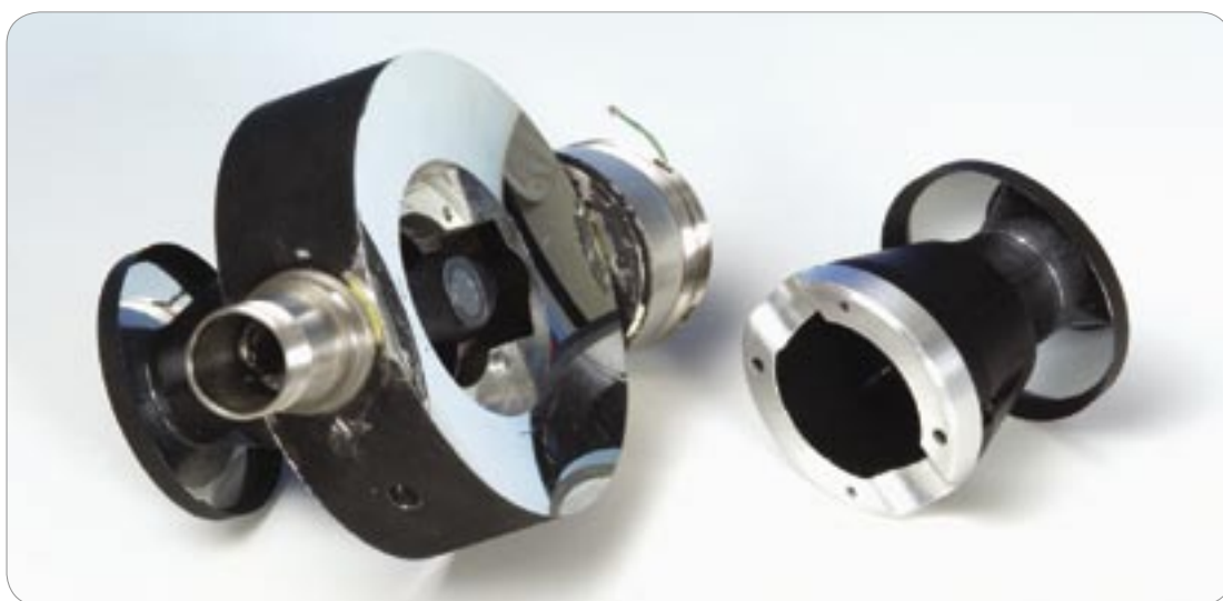
Janusoptikken med hovedspeil og to sekundærspeil. Det ene sekundærspeilet er tatt ut og ligger ved siden. Den ene siden av Janusdetektoren ses midt i primærspeilet. Systemet roterte og signalspenningen ble tatt ut over sleperinger.
